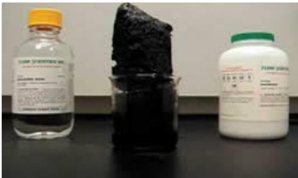
Figura 1. Formação do bloco de carvão a partir de açúcar e ácido sulfúrico.
